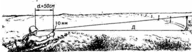
Рис.8 Измерение расстояния до столба по линейным размерам предмета.
